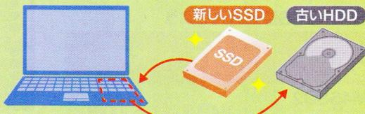
図1 基本的な交換手順は、ノートパソコンもデスクトップパソコンも同じ。まず、新しいSSDをUSBの外付けケーブルで接続し、古いHDDにあるデータをSSDにコピー。それから、パソコンからHDDを取り外してSSDを取り付ける
