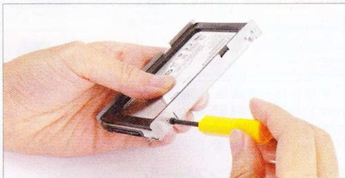
図22 先ほど外した4つのネジで、今度はSSDに金具を固定する。ネジが小さいため、作業中に紛失するトラブルが多い。落としてもなくさないよう、広い机の上などで作業しよう
