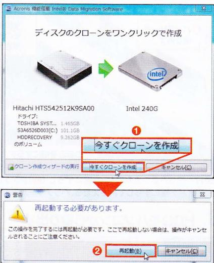
図14 続けて「今すぐクローンを作成」を選択したら、①「再起動」をクリック、②ソフトの指示に従ってパソコンを再起動する
