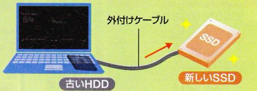
② 古いHDDを取り外し新しいSSDを取り付ける
