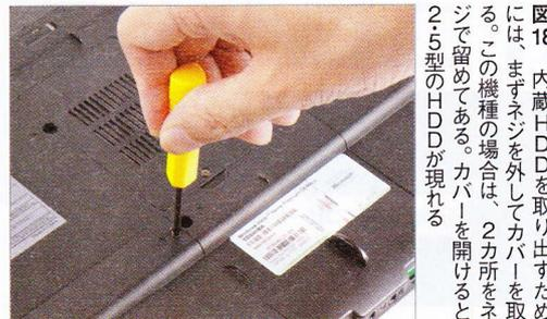
図18 内蔵HDDを取り出すためには、まずネジを外してカバーを開ける。この機種の場合は、2カ所をネジで留めてある。カバーを開けると2.5型のHDDが現れる
